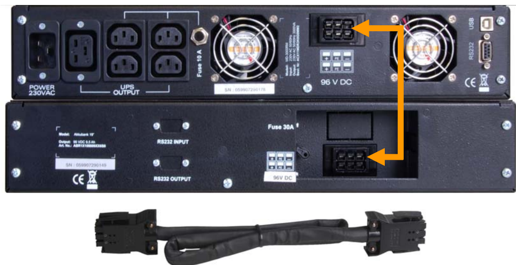
Abb. 7: Verbindung von USV und der Akkubank.
